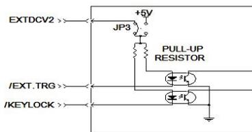
控制信号输入电路
