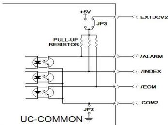
控制信号输出电路
