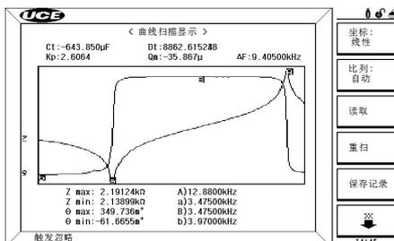
图 3- 8-2 超声器件的测量参数显示
