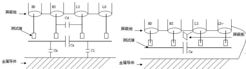
图 7-1 杂散电容的影响示意图
